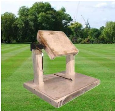
Gambar 3. Rangkaian Penyangga Pasang motor servo pada rangka, yang akan mengontrol gerakan panel surya.
