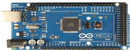
Gambar 1 Tampilan Depan Arduino Mega 2560
